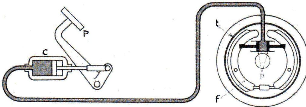
Une poussée sur la pédale **P** entraîne un accroissement de la pression dans le cylindre **C**; cette augmentation de pression est transmise par le liquide aux pistons **p** qui repoussent les freins **f** contre les tambours **t**.
